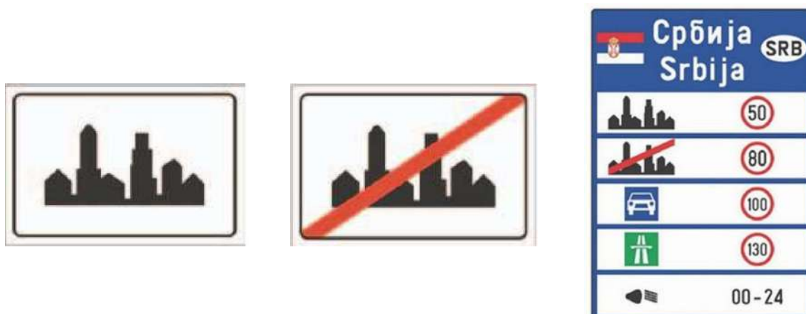
Слика 11.5 – Саобраћајни знакови за почетак/завршетак насеља и информациона табла о општим ограничењима брзине која важе на територији државе (Правилник о саобраћајној сигнализацији („Сл. гласник РС“, бр. 85/17 и 14/21))
