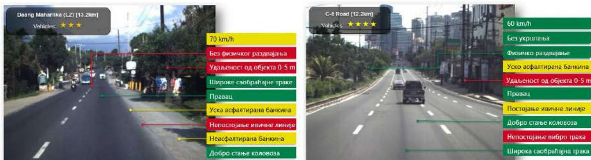
Слика 16.10 – Пример оцене безбедносних карактеристика два различита пута кроз насеље (лево је пут са три звездице, а десно пут са четири звездице) (Извор: https://irap.org/ )
