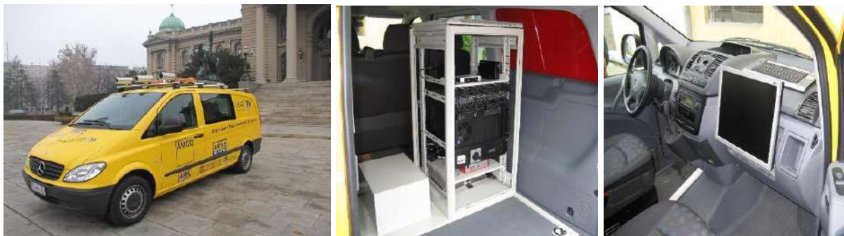
Слика 16.7 – Пример специјализованог возила и дела опреме која се користи за снимање путева
