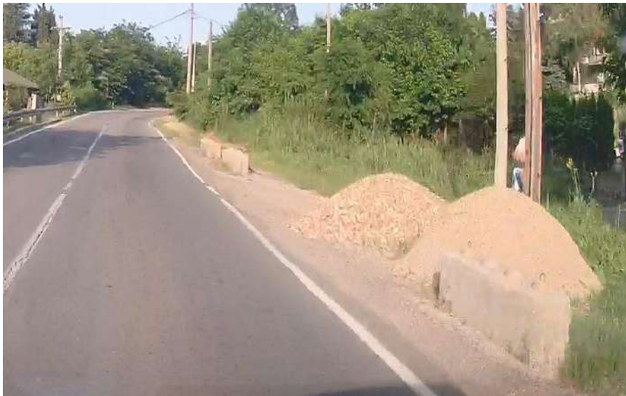
Слика 14.99 – Пример пасивно небезбедних елемената који се налазе уз пут
