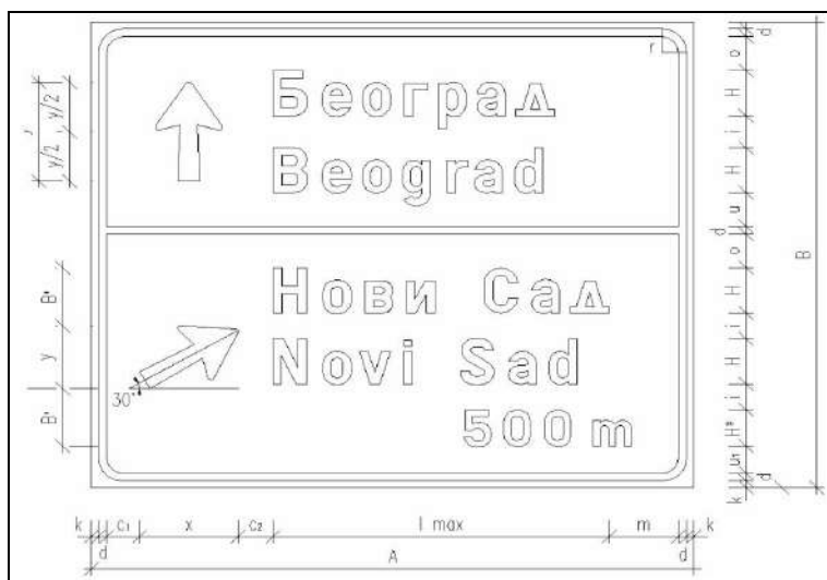
Слика 4.6 – Извод из СРПС стандарда – претпутоказ за излаз са ауто-пута
