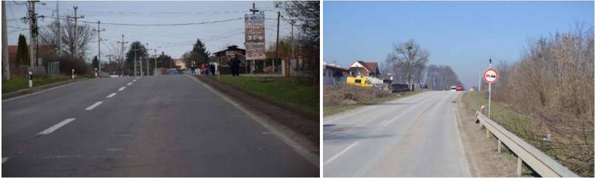
Слика 14.39 – Немогућност уочавања пружања трасе пута након превоја пута
