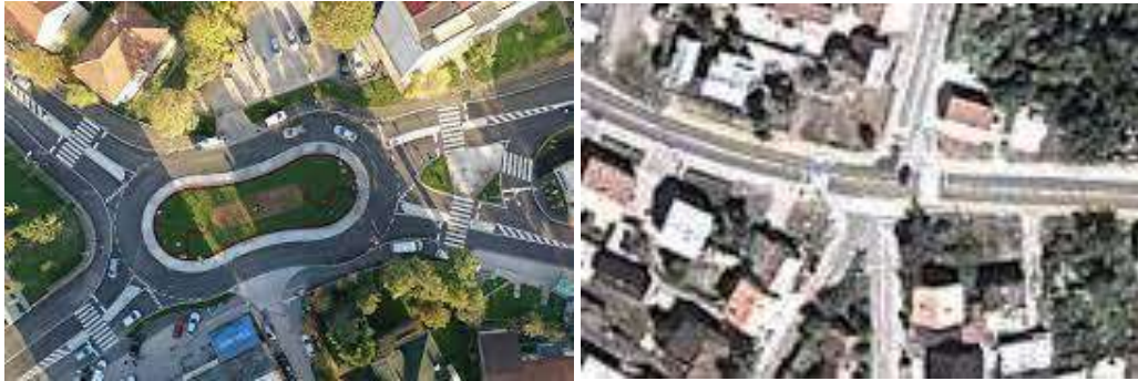
Слика 14.59 – Раскрснице неправилне геометрије
