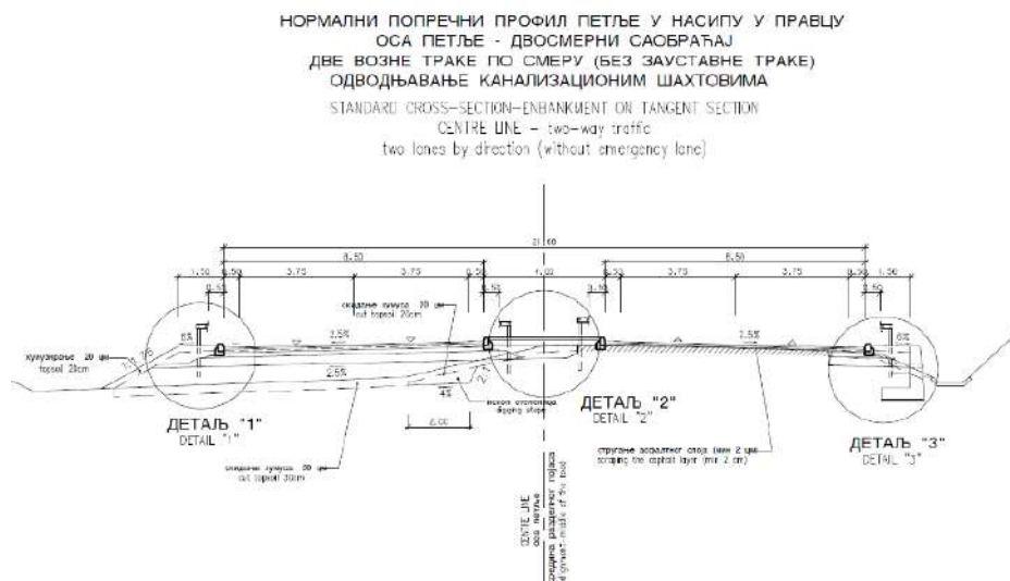
Слика 15.4 – Пројектно решење НПП двосмерне рампе са неусклађеним типом оивичења коловоза и положаја заштитне оградe
