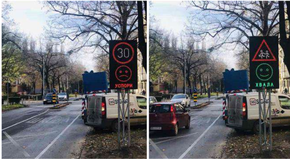
Слика 15.20 – Пример променљиве сигнализације испред пешачког прелаза
