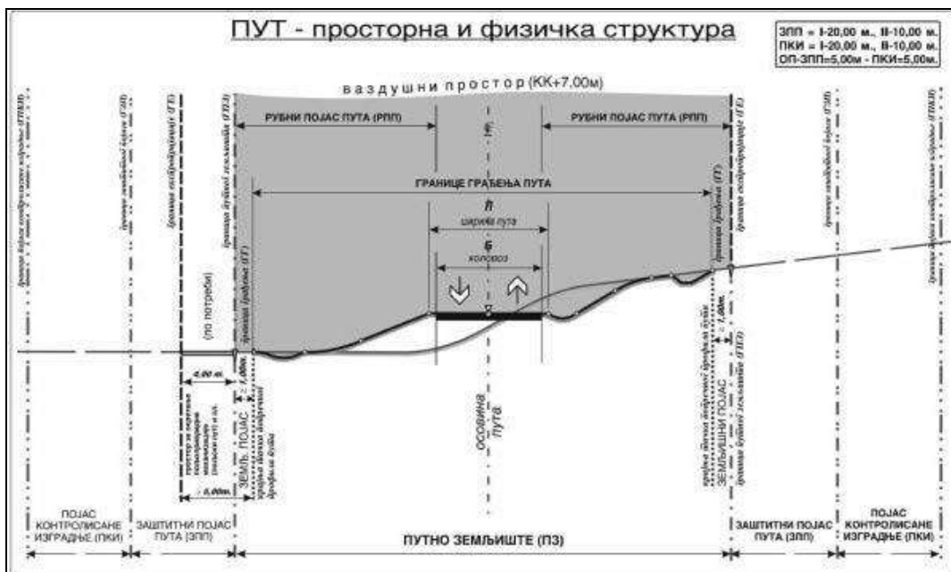
Слика 3.1 – Елементи просторне и физичке структуре двотрачног пута
