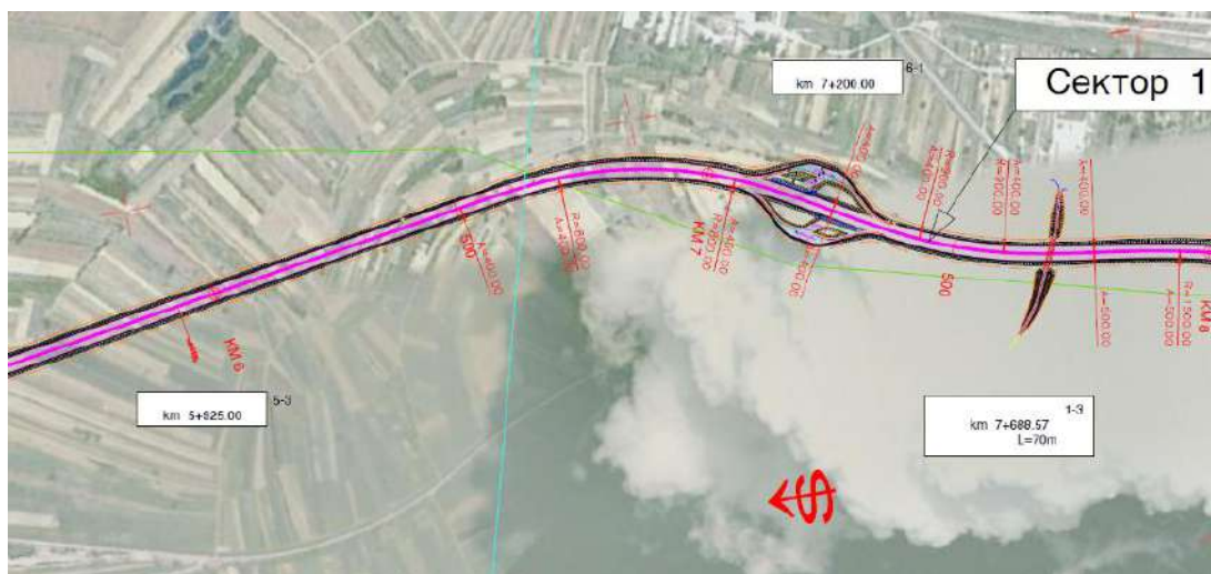
Слика 15.8 – Проектовано решење: Дугачак правац испред кривине минималног радијуса и излазна трака за паркиралиште после оштре кривине
