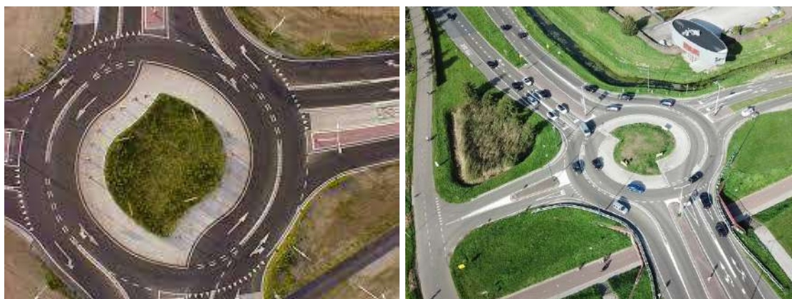
Слика 14.56 – Примери турбо кружне раскрснице
