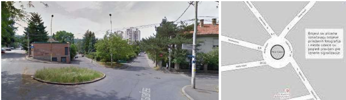
Слика 15.55 – Пример кружне раскрснице небезбедне геометрије
