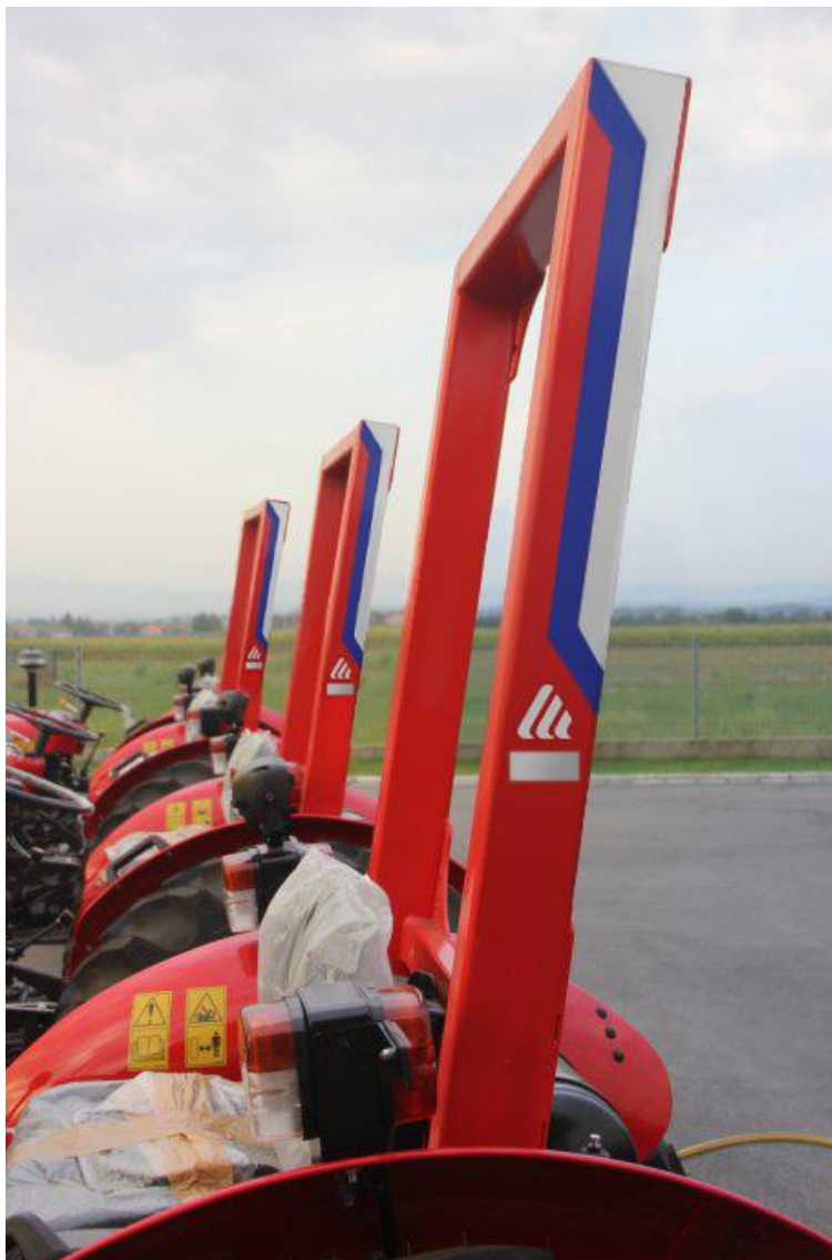
Слика 3.2. Изглед Универзалног заштитног рама постављеног на трактор
