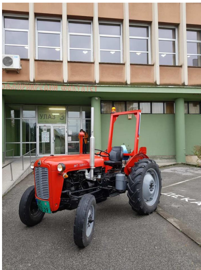
Слика 4.4. Универзални заштитни рам уграђен на трактор ИМТ 539
