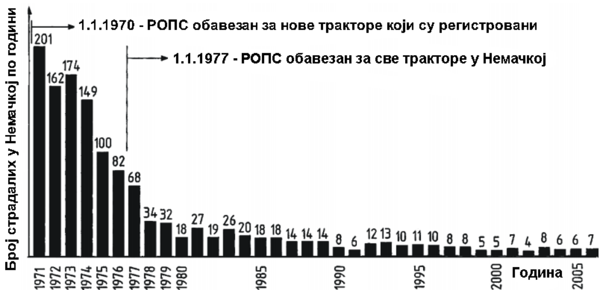
Слика 1.3. Превртања трактора са смртним исходом у Немачкој у периоду од 1971 до 2006. године ( Röthemeyer, 2013 )
