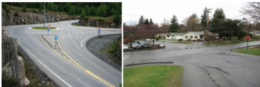
Слика 53. Безбедно пројектовано укршћање (лево) и небезбедно пројектовано укршћање (десно)
