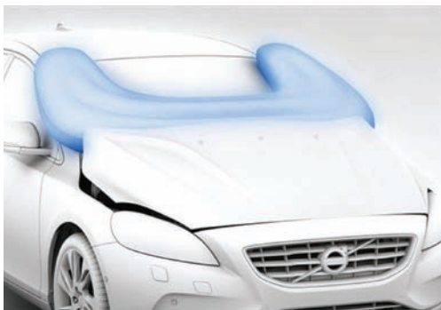
Слика 41. 'Air bag' као заштитна јешака при судару јешака
